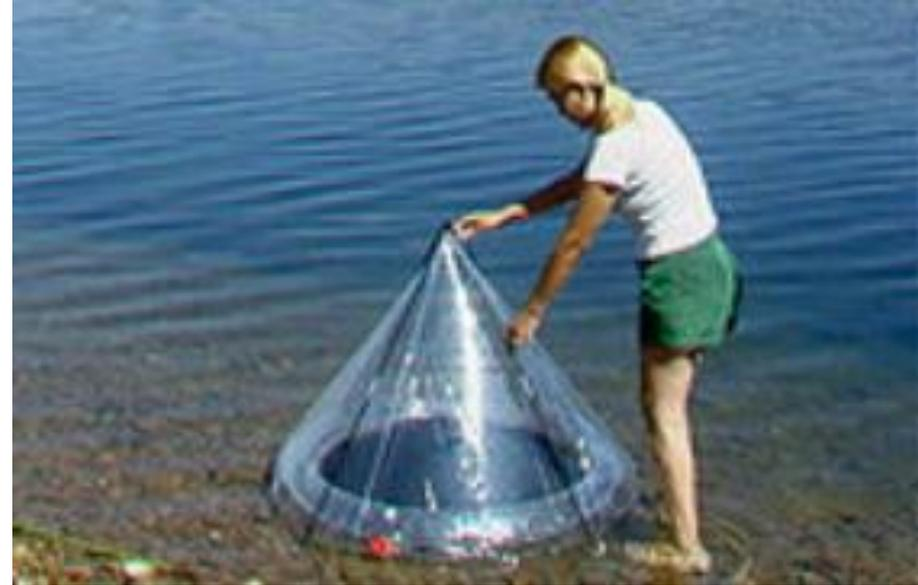
AquaCone. Es un destilador muy ligero y flotante diseñado para destilar agua directamente en espacios acuáticos, ya sea de un lago, un río, el mar o incluso una alberca. Produce 1.5 y 2.5 litros de agua destilada en verano con una superficie de  $1.06 \text{ m}^2$ . Su costo es de 200 dls.
