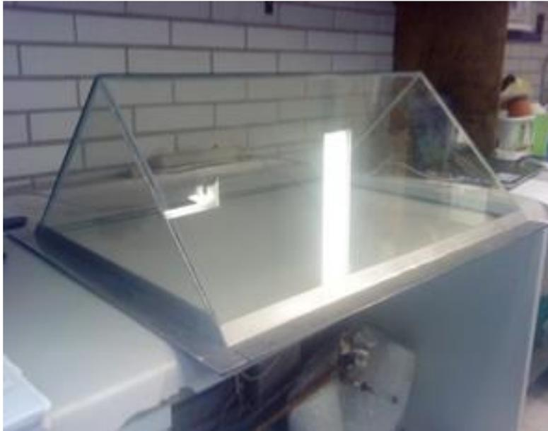
Para la construcción del condensador se cortó una hoja de vidrio de 6 mm de espesor, dos con forma de triángulo equilátero de 57.66 cm de base por 28.66 cm de altura y dos en forma rectangular de 78.02 cm de base por 28.66 cm de altura de acuerdo a las mediadas del diseño. Para asentar el condensador sobre la charola se utilizó lámina de aluminio calibre 20 recortada y doblada en ángulo de acuerdo al diseño. Para evitar fugas, como empaque se colocó hule recortado.
